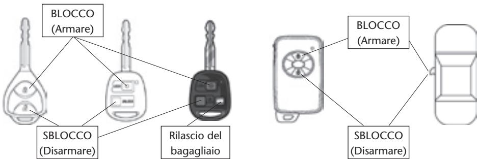
L'impianto di allarme viene armato quando si chiude a chiave la vettura e disarmato quando si apre la vettura con la chiave.
