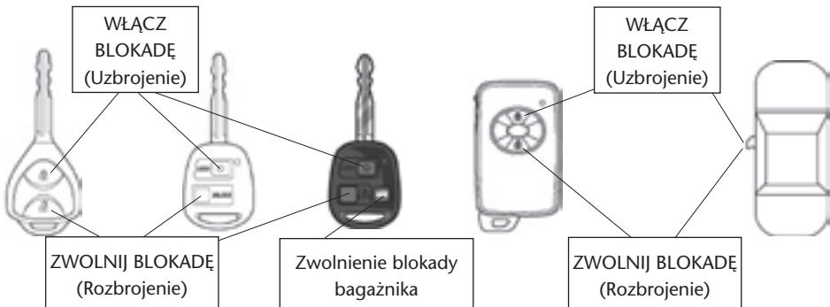
System alarmowy może zostać uzbrojony w czasie włączania blokady samochodu, natomiast rozbrojony podczas zwalniania blokady.
