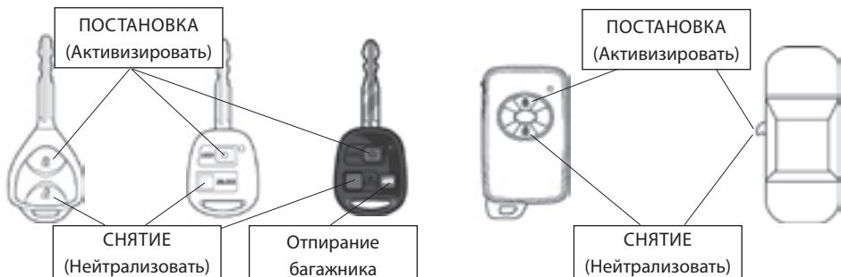
Система сигнализации активизируется одновременно с запиранием автомобиля и нейтрализуется при отпирании автомобиля.
