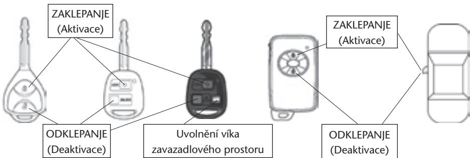
Systém alarmu se aktivuje současně se zamknutím vozu a deaktivuje se odemknutím vozu.
