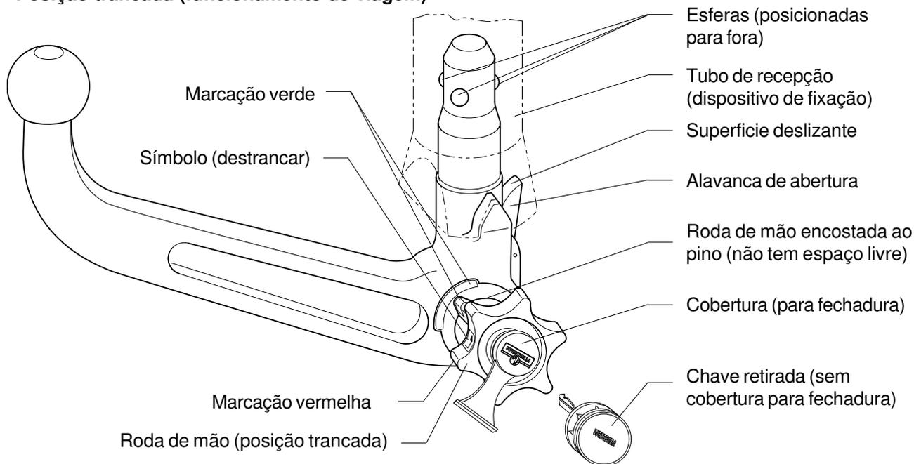
**Posição não trancada (acoplamento não montado)**
