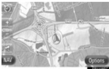
Le signal GPS peut-être être physiquement entravé, ceci conduisant à une indication inexacte de la position du véhicule sur l'affichage de la carte. Les tunnels, les immeubles de grande hauteur, les camions voire même les objets placés sur le tableau de bord peuvent entraver les signaux GPS.
