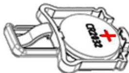
⑥ Volte a colocar o suporte da pilha deslizando-o na direção indicada
