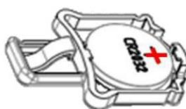
⑥ Sätt tillbaka batterihållaren genom att skjuta den i angiven riktning
